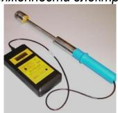
Прибор ЭСПИ-301 предназначен для измерения биологически опасных уровней электростатического поля.
